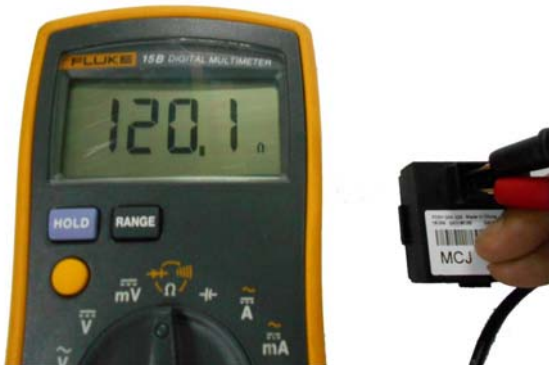
شکل 2-7 روش اندازه گیری مقاومت شبکه های CAN
