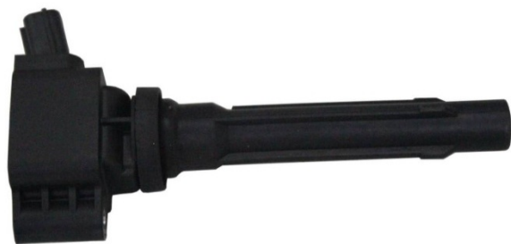
کانکتور کوئل (محل اعمال ولتاژ پایین)
